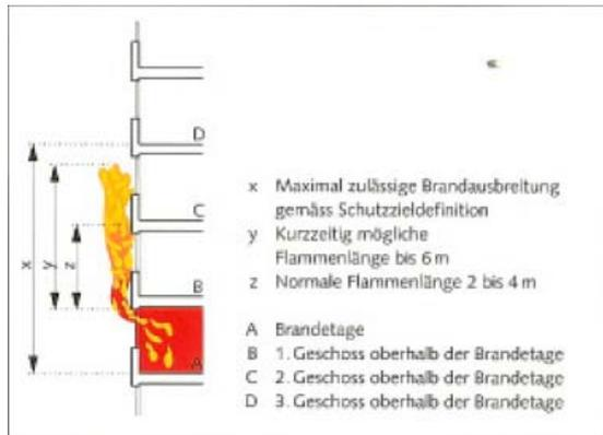
Gemäss der Lignum Dokumentation Brandschutz <<7.1 Aussenwände – Konstruktion und Bekleidung>> gilt für Aussenwände folgendes, generelles Schutzziel:
