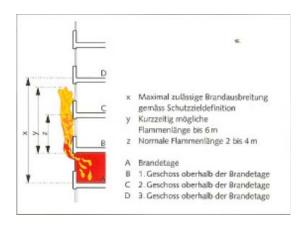
Gemäss der Lignum Dokumentation Brandschutz <<7.1 Aussenwände – Konstruktion und Bekleidung>> gilt für Aussenwände folgendes, generelles Schutzziel:
